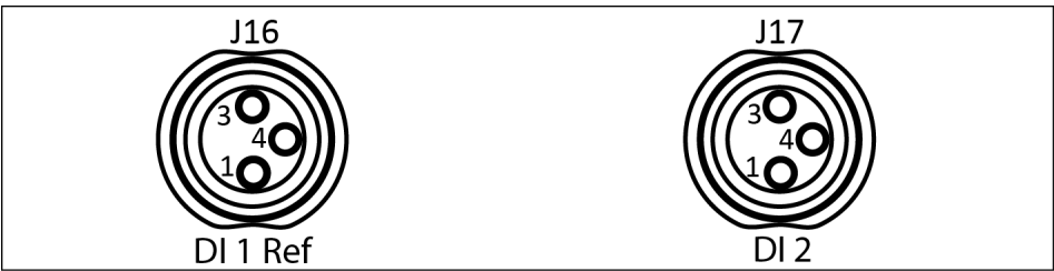
PIN-Belegung Stecker Digitale Eingänge
